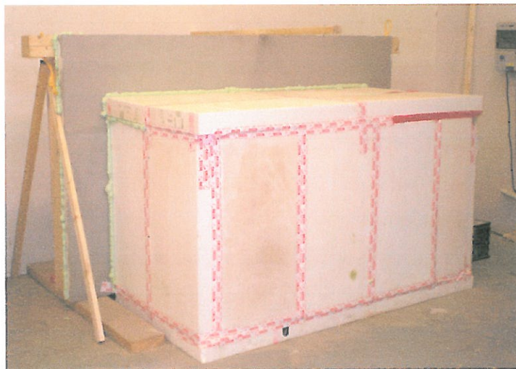
Foto 2. Pohled na posuzovaný vzorový panel obvodové stěny montované dřevostavby
